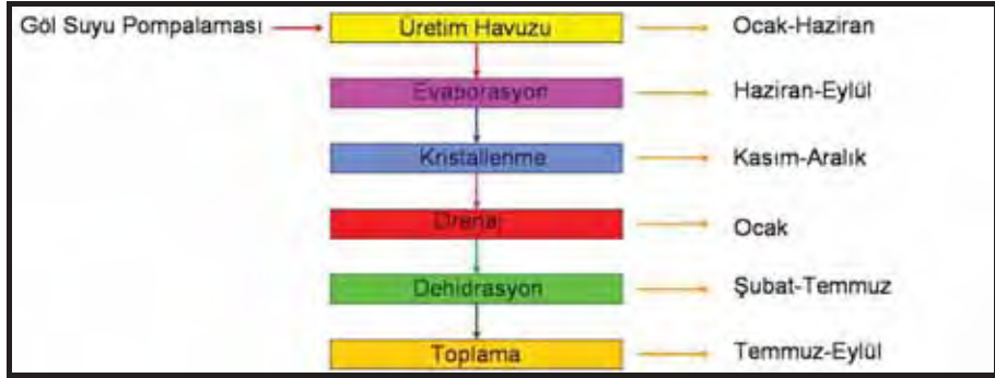
Şekil 10. Doğal yollarla sodyum sülfat üretim aşamaları.
