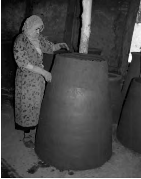
Şekil 12. Tandır Yapımında Bantların Düzlenmiş Görünüşü
