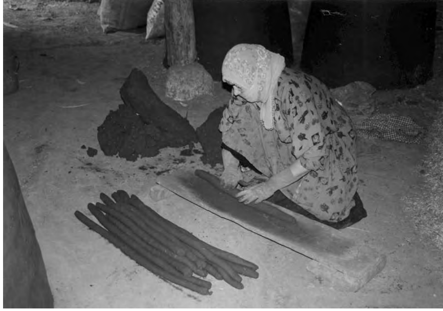
Şekil 8. Tandırın Yapımında Bantların (Loloz) Hazırlanması
