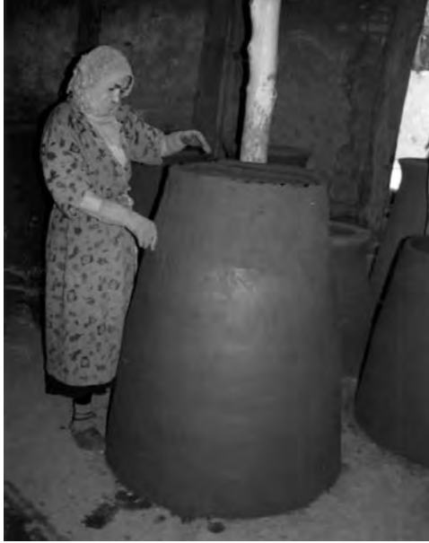
Şekil 12. Tandır Yapımında Bantların Düzlenmiş Görünüşü
