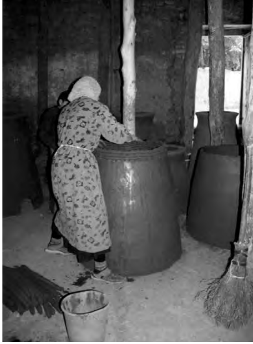
Şekil 10. Bantların Üst Üste Konulması İle Devam Eden Tandır Yapımı
