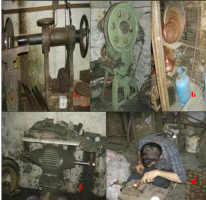
Şekil 2. Bakırcılıkta kullanılan makineler(a. Polisaj makinesi, b. Sıvama makinesi, c.Pürmüz, d. Perdahlama, e. Kaynak makinesi)
