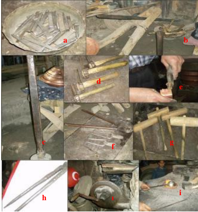
Şekil 1. Bakırcılıkta kullanılan el araçları (a. Kalemler, b. Nay eşiği, c. Endirek, d. Ablasım e. Diş makası, f. tel makası, g. Tokmaklar, h. Pergel, i. Körük, i. Ocak)
