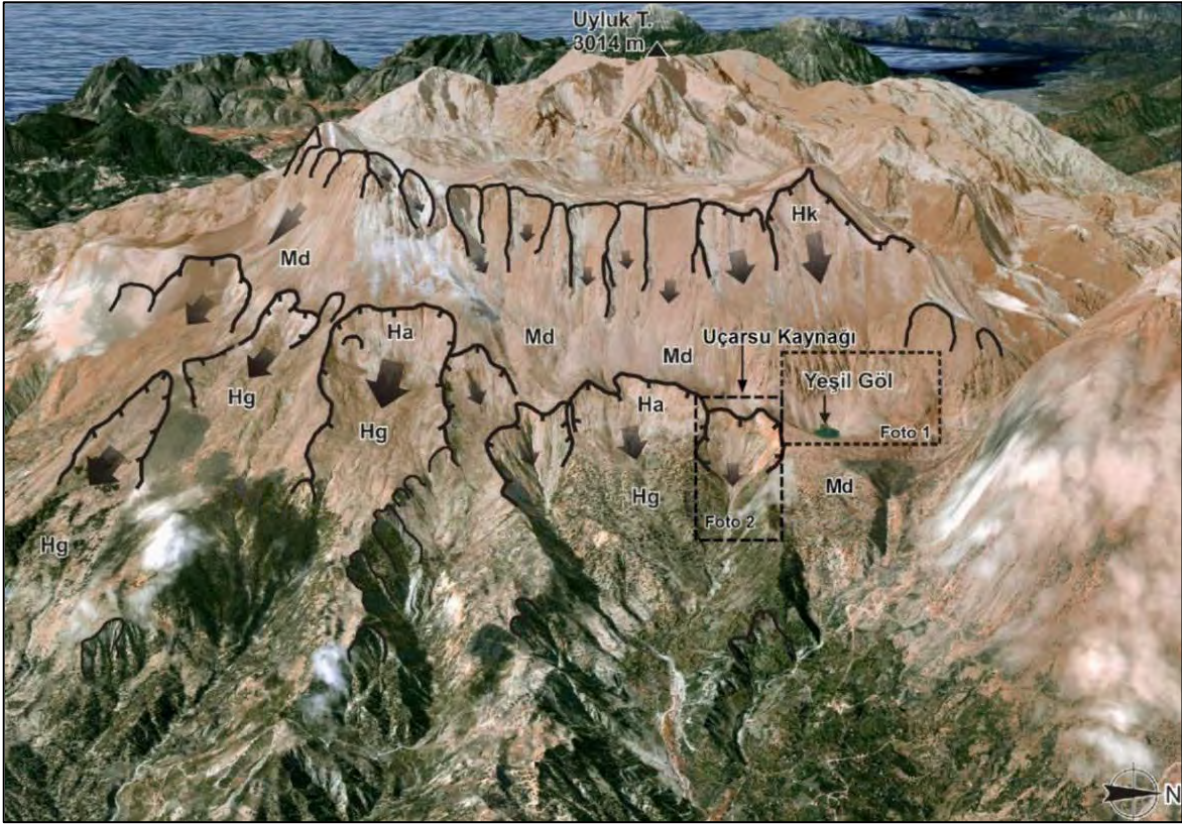
Şekil 2. Akdağ doğusundaki heyelan sahaları ve Yeşil Göl heyelanı (GeoEye 2009). Ha: Heyelan aynası, Hg: Heyelan gövdesi, Hk, Heyelan kaynak alanı, Md: Moloz deposu.
